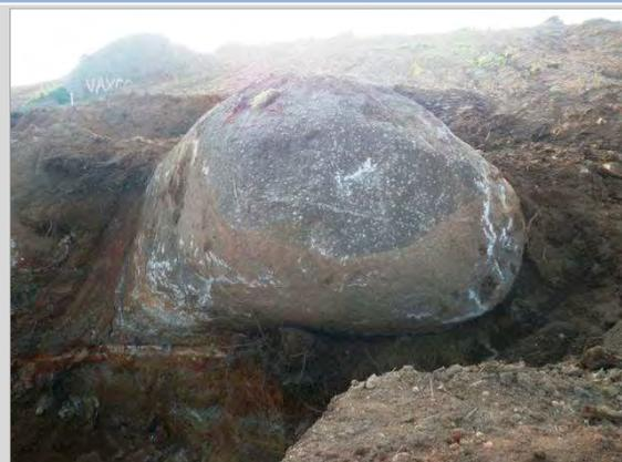
Foto 12 – Matação com esfoliação esferoidal com núcleo preservado em área de movimentação de terra (Ponto 15) ao longo da Avenida Bariloche na divisa de Barueri e Carapicuíba
