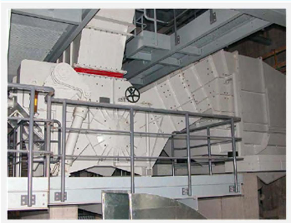
As cinzas e escórias úmidas serão extraídas a uma taxa de aproximadamente 1630 kg/h (vazão normal) e 4823 kg/h (como vazão de projeto) a 60°C. A quantidade de cinzas e escórias geradas na queima dos RSU é estimada em 14% da alimentação.
