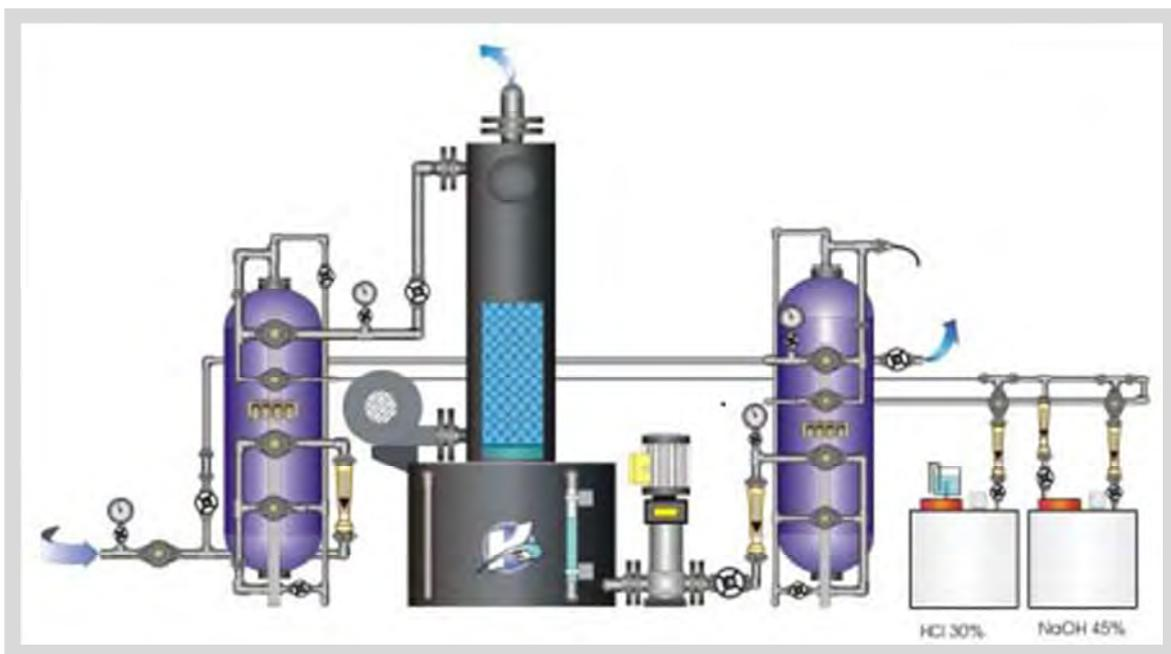
A água desmineralizada será utilizada na reposição de água da caldeira, injeção de ureia na caldeira e nos superaquecedores da caldeira. A qualidade da água da caldeira deverá atender a Norma Alemã VGB R450L ou Norma Européia EM 12952-12.
