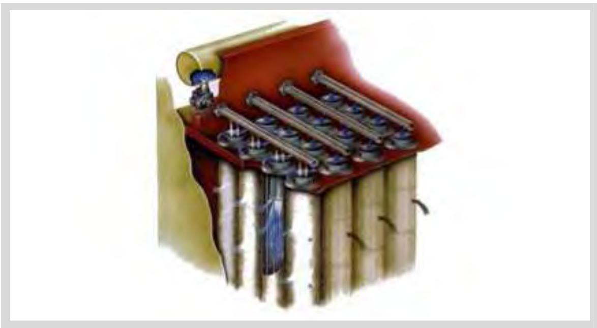
A câmara do filtro será uma construção de folhas de aço soldadas com reforços externos de aço. As seções do separador serão fornecidas dentro das câmaras para separar os lados do gás cru e do gás limpo. Essas seções têm aberturas para o encaixe das mangas dos filtros com fixadores de encaixe. Os funis debaixo das câmaras de filtro serão construídos em folhas de aço soldadas e equipados com portas de acesso.
