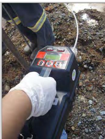
Foto 32 – Medição de vapores orgânicos no solo superficial com *Gastech*.
