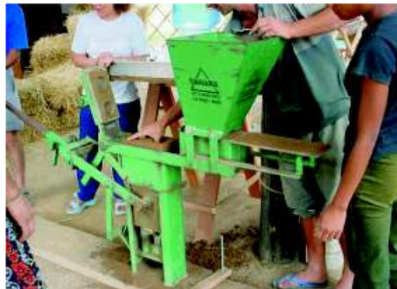
Figura 86: Prensa tijolo tipo modular (Instituto de Permacultura da Pampa, Bagé/RS).
