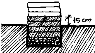
Figura 35: fundação com camada de brita e fiadas preenchidas com uma mistura de solo e cimento.
